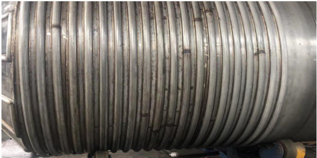
不锈钢无缝盘管在我们如今的生活中的使用还是很多的，它主要具有以下的这些特性：1、在氧化和还原这两种环境中，不锈钢无缝盘管对于大多数腐蚀介质都是有着很好的耐腐蚀性能的。2、它具有较好的耐点蚀、缝隙腐蚀和应力腐蚀的性能。3、不锈钢无缝盘管适用于各种浓度的硫酸溶液，具有不错的使用效果。4、因为材质的原因，所以无缝盘管它本身就具有很好地防锈能力，保证了我们的使用。这些都是不锈钢无缝盘管所具有的性能，这些性能也保证了它的使用性能。我们生活中对于不锈钢无缝盘管的使用，可以说是相当的\*\*\*了，我们在使用的时候还需要注意到它的保养工作，这样才可以获得更好的使用效果。1、我们在保养不锈钢无缝盘管的实时需要每隔半个月就使用抹布擦掉灰尘。2、事实上不锈钢无缝盘管的工艺能够直接决定它的局限性能，并且我们在清洗的时候可以使用清水进行清洗。3、如果需要检测或者是整形不锈钢无缝盘管，那么一定
